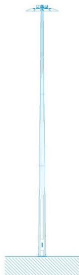
Figura 4 – Torre faro con corona mobile (con fusto infisso o tirafondi alla base)
