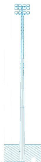
Figura 3 – Torre faro di tipo fisso senza accessori di salita o stazionamento (con fusto infisso o tirafondi alla base)
